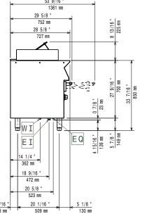
Electrical inlet (power) ΕI Equipotential screw
